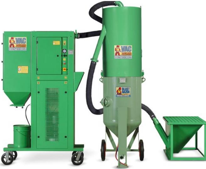
VAC-5 Strahlmittel Rückgewinnungssystem ist eine elektrisch betriebene Vakuum-Sauganlage mit einem integrierten leistungsfähigen Patronenfilter mit Pulse-Jet Abreinigung, einem Strahlmittel-Vorratsbehälter für das automatische Wiederbefüllen des Strahlkessels (unmittelbar montiert an dem Contracor Z-200 Serie Strahlkessel) und ist zusätzlich mit einem Bodentrichter mit Saugschläuchen und einem Gitterrost ausgestattet.
