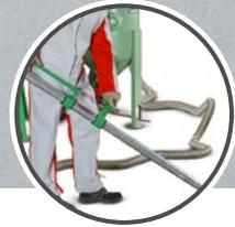
Optional mit Handsaugrohr mit Stützrädern und Handgriff.
