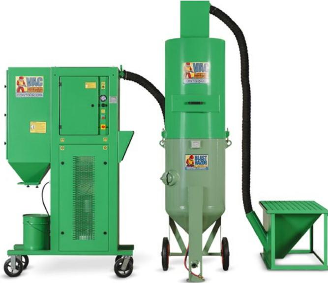
VAC-7 Strahlmittel Rückgewinnungssystem ist ein elektrisch betriebenes Vakuum-Strahlmittel-Rückgewinnungssystem, ausgestattet mit einem extra leistungsfähigen Seitenkanalverdichter und einem hoch-effektiven Kaskaden-Reiniger. Das VAC-7 Strahlmittel Rückgewinnungssystem verfügt, im Vergleich zu der regulären Ausführung VAC-5, über eine erhöhte Saugleistung und einer besseren Reinigungsleistung.
