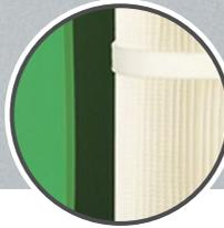
Patronenfilter mit automatischer Impulsreinigung.
