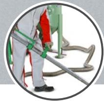
Optional mit Handsaugrohr mit Stützrädern und Handgriff.
